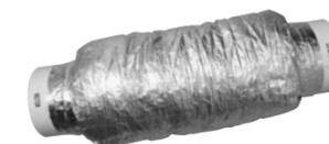
**Airsoft 2:** Los modelos de techo disponen opcionalmente de un panel rígido de 25 mm. de espesor de lana mineral, con una capa exterior de protección de aluminio y un recubrimiento interior en tejido fonoabsorbente. El conducto **Airsoft 2** reduce hasta en un **15%** (4dB) el sonido percibido de la campana.
