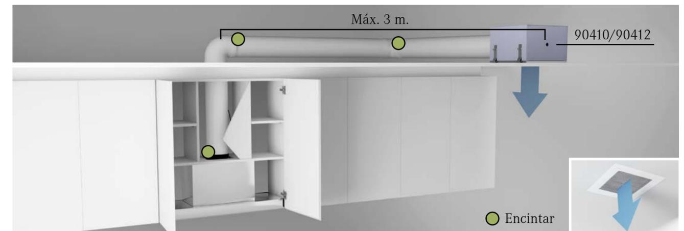
En campanas de integración con falsos techos se puede instalar también el Plasma C600 + Cajón o C1000 + Cajón en el falso techo. Para ello basta con conducir la salida de aire por el falso techo hasta la ubicación del Filtro de Plasma. Para un funcionamiento óptimo se recomienda alejar el filtro de plasma lo máximo posible sin superar los 3m.
