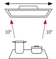
La distancia de instalación afecta directamente a la capacidad aspirante de la campana y a la condensación. Siga estas instrucciones para garantizar el buen funcionamiento de su campana.
