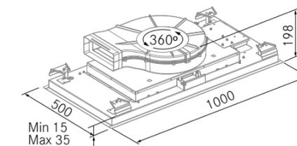
Diseño técnico (Motores Exteriores)
