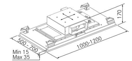
La campana TR10 Slim se instala a falso techo, para ello, este debe poder soportar un peso de **30/35 kg.**
