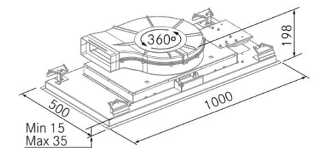
La campana Bright 360 se instala a falso techo, para ello, debe poder soportar un peso de **30 kg.**
