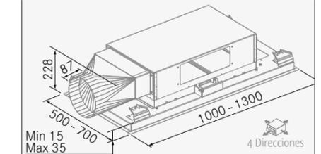
La campana se instala a falso techo, para ello, este debe poder soportar un peso de **30/35 kg.**
