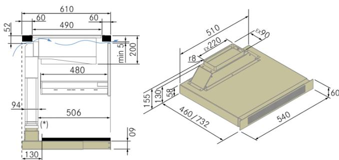
\* Requiere adaptador Optiflow - IT (90348) + conector plano IT (90337).
