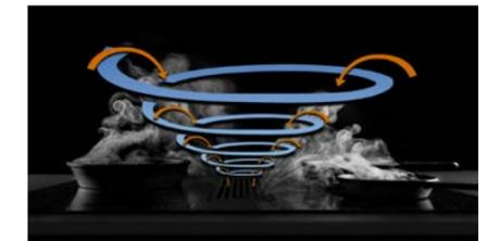
La Zona de aspiración de la Flow Pour gracias a su diseño, produce un flujo de aire de alta velocidad generando un efecto de atracción que se amplía a mayor altura atrayendo los humos hacia el centro y llevándolos hacia su interior.
