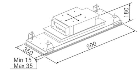
La campana Aero se instala a falso techo, para ello, este debe poder soportar un peso de sólo **20 kg**.
