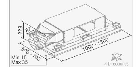
La campana SCL 360 se instala a falso techo, para ello, este debe poder soportar un peso de **30/35 kg.**
