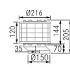
Los aparatos de Plasma redondos FRECAN extraen el aire por todo su perímetro reduciendo así la fricción y la presión, por esta razón, para una buena circulación del aire a la salida de los filtros de plasma se recomienda dejar un mínimo de 30 mm. entre el filtro y el tubo decorativo o el cajeadado.
