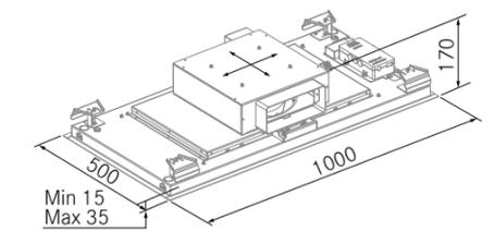
La campana TR9 Slim se instala a falso techo, para ello, este debe poder soportar un peso de **30 kg**.
