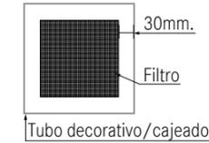
El filtro de carbón activo FC-Plus puede ser instalado a la salida del motor o puede ser instalado en diferido mediante un tubo rígido. Extrae el aire por todo su perímetro reduciendo así la fricción y la presión, por esta razón, para una buena circulación del aire a la salida de los filtros se recomienda dejar un mínimo de 30 mm. entre el filtro y el tubo decorativo o el cajead.
