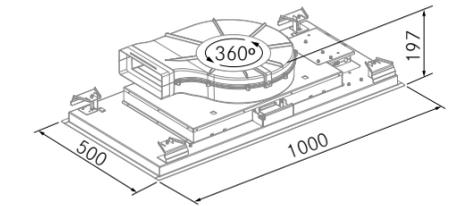
La campana SCL Glass se instala a falso techo, para ello, este debe poder soportar un peso de **30 kg.**
