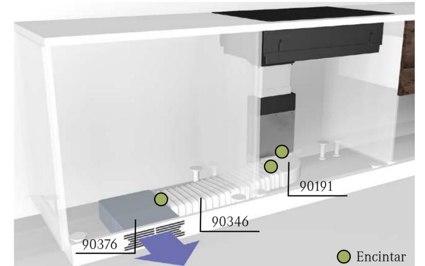
Ejemplo de instalación del sistema de plasma F800 + rejilla cajón a zócalo
