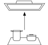
Según la norma UNE-60335-2-31, la distancia mínima de las placas de gas respecto a la parte activa\* de la campana extractora y/o los muebles debe ser de al menos 65 cm.
