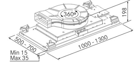
Diseño técnico (Motores Exteriores)
