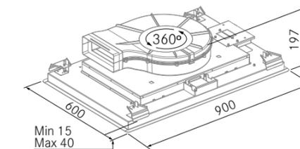
La campana Astro se instala a falso techo, para ello, debe poder soportar un peso de **35 kg.**
