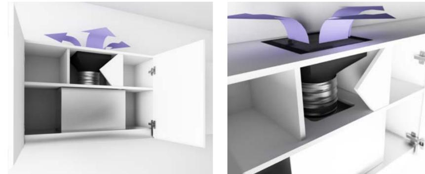
El filtro se instala en la parte superior del mueble, canalizando ya sea con el tubo flexible (incluido) o con un tubo rígido. (opcional).
