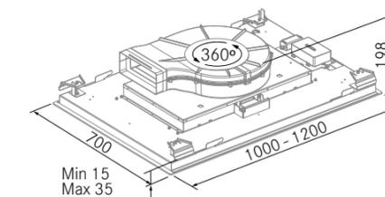
La campana Cloud 360 se instala a falso techo, para ello, este debe poder soportar un peso de **35 kg**.
