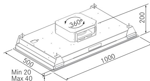
La campana Bright 360 se instala a falso techo, para ello el falso techo debe poder soportar un peso de 30 kg.
